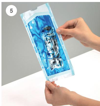
Lassen Sie die Tinte an jeder Siegelnahme ca. 5 Sekunden einwirken. Prüfen Sie alle Siegelnähte auf Dichtigkeit.
