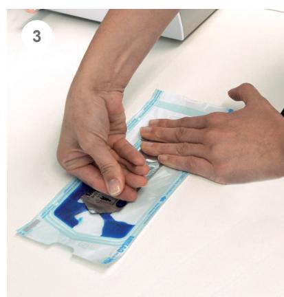
Streichen Sie mit leichtem Druck vom Ende bis zur Spitze über den Tintentest. Der Tintentest wird dadurch geöffnet und die Tinte herausgedrückt.
