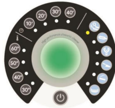
Grünes blinkendes Licht. Drei Minuten bis zum Ende des Spülzyklus.
