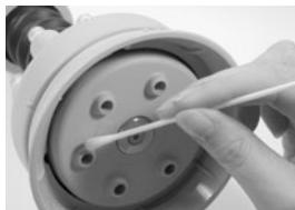
Usare *esclusivamente* una soluzione disinfettante non tossica di Sali di ammonio quaternario al 2% e una soluzione di ipoclorito di sodio al 1%. Pulire la parte inferiore del distributore e dei fori di uscita dei dischetti, utilizzando un tampone.
