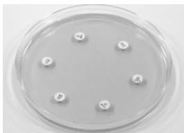
Präzises Aufbringen der Testblättchen in gleichmäßigem Abstand in einem Kreis von 54mm Durchmesser.
