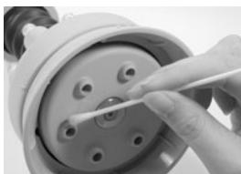
Für die Reinigung nur 1%ige Hypochloritlösung oder Deinfektionmittel auf Basis von nichttoxischen, 2%igen quartären Ammoniumsalzverbindungen verwenden. Unterseite und Austrittsöffnung mit einem Tupfer reinigen.
