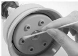
Χρησιμοποιήστε σαν απολυμαντικό μη τοξικό διάλυμα 2% αλάτων τεταρτοταγούς αμμωνίας ή 1% διάλυμα υποχλωριώδους νατρίου. Χρησιμοποιήστε στυλεούς για να καθαρίσετε το εσωτερικό του διανεμητή και τις θήκες των σωληναρίων.
