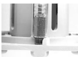
Die automatische Sperrvorrichtung zeigt an, wenn ein oder mehrere Magazine leer sind und verhindert so eine Kontamination der Andruckkolben.
