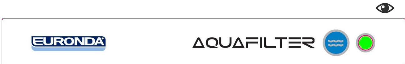
Grün blinkend: Ausgabe an Autoklav 1 im Gang. In diesem Zustand gibt der Aquafilter Wasser an Autoklav 1 ab. Ist die manuelle Entnahme von Wasser erforderlich, ist es ausreichend, die Taste für den manuellen Befehl zu drücken. Solange wie die Taste gedrückt gehalten bleibt, ist die Ausgabe zum Autoklav blockiert und das Wasser wird an den Schlauch für die manuelle Entnahme abgegeben.
