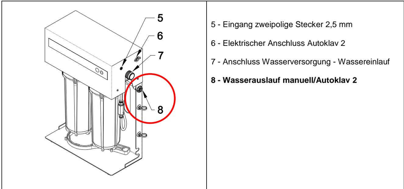
Durch Gedrückthalten der Taste für den manuellen Befehl den Aquafilter einschalten.
