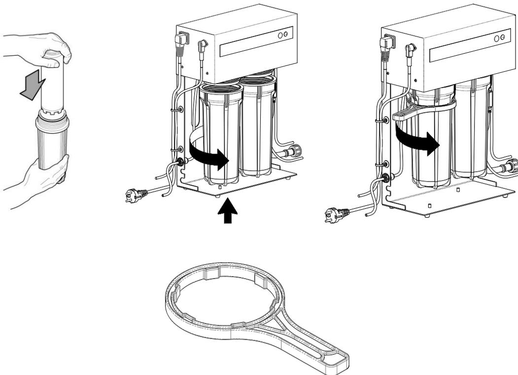
Hinweis: Die Behälter mit dem entsprechenden Schlüssel in der vom Pfeil angegebenen Richtung festschrauben. **SIND DIE EINSÄTZE EINMAL INSTALLIERT, SO DÜRFEN SIE ERST NACH IHREM VOLLSTÄNDIGEN VERSCHLEISS WIEDER ENTFERNT WERDEN.** Andernfalls könnte die hydraulische Dichtung beschädigt werden.
