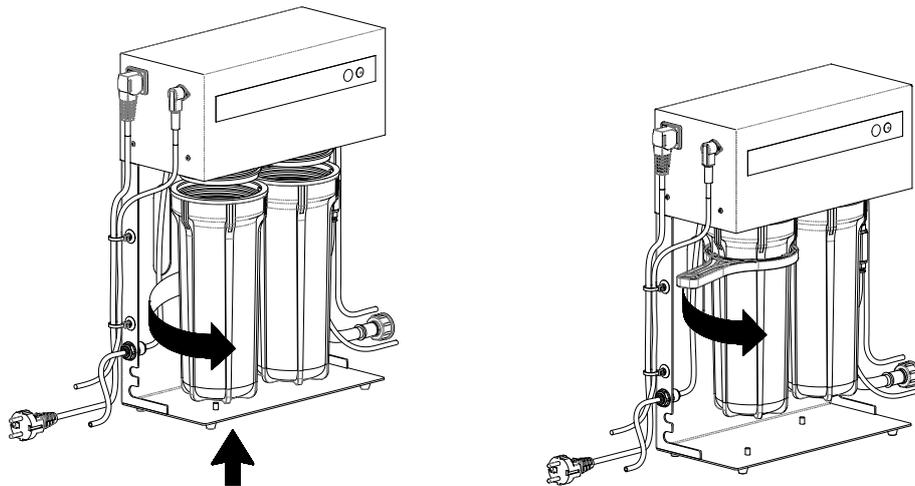
Den Aquafilter wieder einschalten, dabei die Taste für den manuellen Befehl gedrückt halten; die Taste weiter gedrückt halten, bis das Wasser aus dem Schlauch für die manuelle Entnahme tritt (Wasserauslösung).
