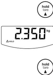
Wenn Sie die HOLD-Funktion aktivieren, wird der Gewichtswert nach Entlastung der Waage weiterhin angezeigt. So können Sie den Säugling versorgen, bevor Sie den Gewichtswert notieren.
